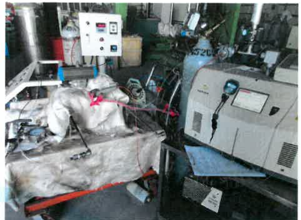
照片二 閥桿洩漏量測過程 Picture 2 View of Emission Test
