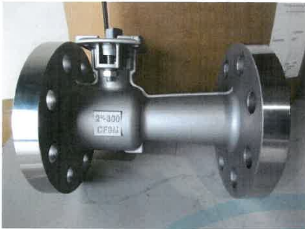
照片一 測試樣品(球閥 2 inch Class 300) Picture 1 Test sample (Ball Valve 2 inch Class 300)
