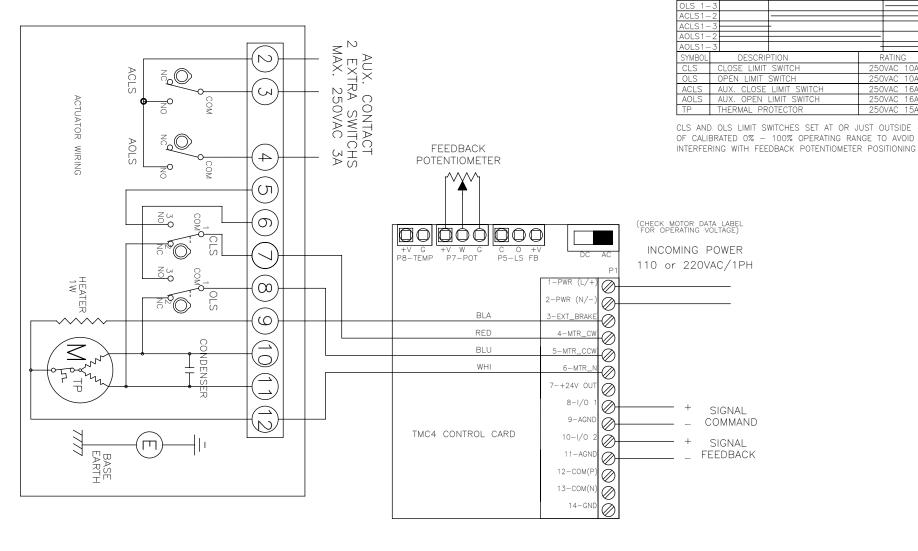
TORQUE AND LIMIT SWITCH OPERATION
